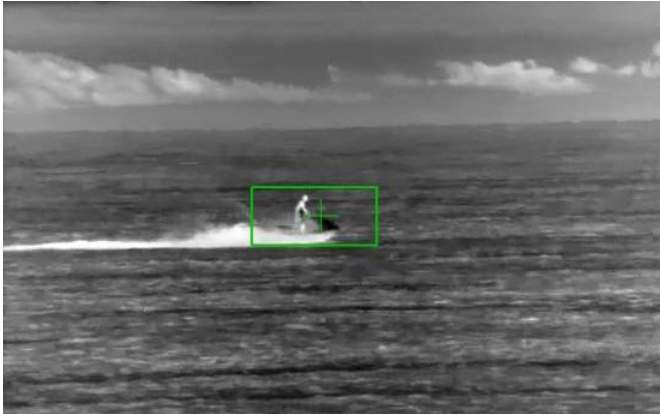
Tracking a jet-ski using IR video
